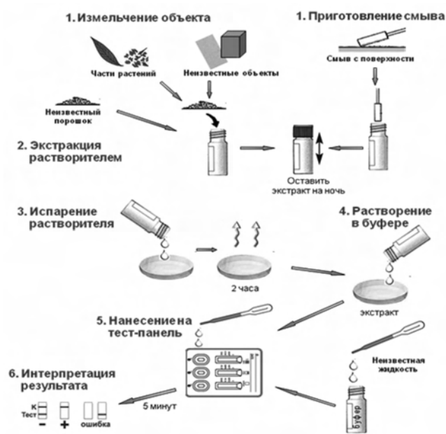
Рис. 3. Схема проведения пробоподготовки и ИХА ПАВ в различных объектах.
